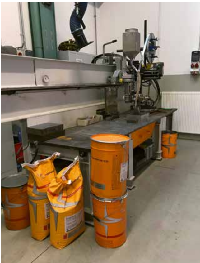
Versuchsstand zur Durchführung von UP- und RES-Kundenversuchen
